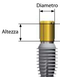
L'altezza del moncone Locator® viene misurata dall'estremità inferiore della parte in oro del moncone Locator® alla spalla del moncone. Le altezze sono 1.0, 2.0, 3.0, 4.0 o 5.0mm.
