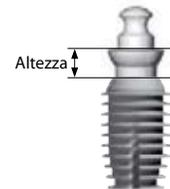
L'altezza del moncone Brevis™ viene misurata dall'estremità superiore dell'impianto alla spalla del moncone. Le altezze sono 2.0, 4.0 o 6.0mm. L'altezza totale dall'estremità superiore dell'impianto all'estremità superiore del moncone è di ca. 5.0, 7.0 o 9.0mm rispettivamente.
