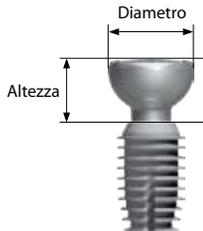
Il diametro effettivo del moncone provvisorio tiene conto del diametro del moncone definitivo con spazio per una cuffia in policarbonato. L'altezza del moncone viene misurata dall'estremità superiore dell'impianto all'estremità superiore del moncone provvisorio.
