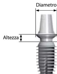
L'altezza del moncone Stealth a spalla preformata viene misurata dall'estremità superiore dell'impianto alla spalla del moncone. Le altezze sono 1.5, 2.0, 3.0, 3.5, 4.0, 6.0 o 8.0mm, in base al diametro del moncone. L'altezza del gambo del moncone è variabile.
