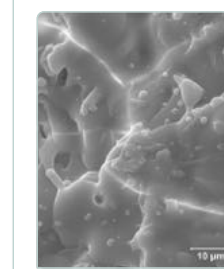
Bicon superficie in Idrossiapatite (HA)
