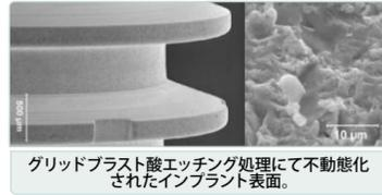
グリッドプラスト酸エッチング処理にて不動態化されたインプラント表面。
